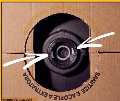
Posicione corretamente a válvula nos dentes do encaixe.
