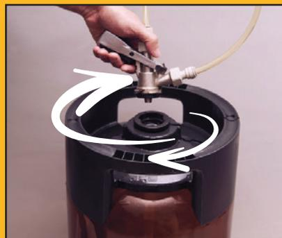
Verifique se a alavanca da extratora está totalmente levantada para encaixar no barril e gire no sentido horário até travar.
